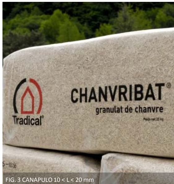
FIG. 3 CANAPULO 10 < L < 20 mm
